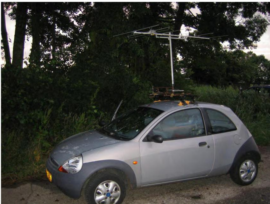
Figuur 4.2. Auto uitgerust met antenne om gezenderde Meervleermuizen te volgen (Foto: A&W).
